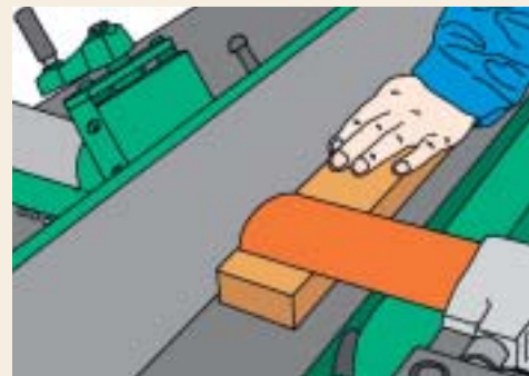
▲ Dans le cas du dégauchissage à plat d'une face, le pont est préréglé en hauteur en fonction de l'épaisseur de la pièce à dégauchir.
