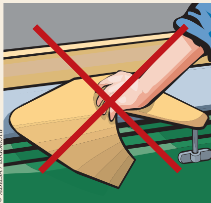
▲ Le protecteur escamotable ne protège pas la main droite en fin de passe.
